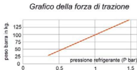
Il grafico illustra la pressione del refrigerante necessaria per trainare una barra in funzione del suo peso, e con un coefficiente d'attrito valutato < 0,2
